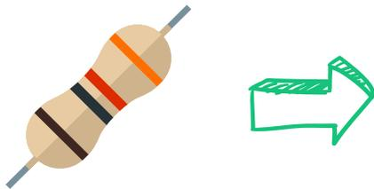
Resistores são componentes eletrônicos que são usados para limitar a corrente elétrica que passa através deles. Eles são essenciais em circuitos eletrônicos para controlar a quantidade de corrente que passa para evitar danos aos componentes do circuito.
